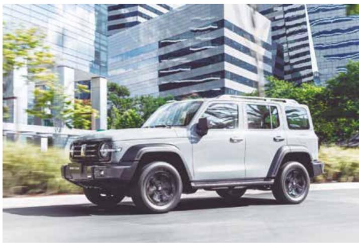
Equipado com um motor 2.0 turbo de injeção direta a gasolina acoplado a um motor elétrico no eixo dianteiro, o veículo entrega 394 cv de potência combinada e 750 Nm de torque combinado, o que garante força e desempenho excepcionais tanto nas rodovias quanto em terrenos desafiadores.
